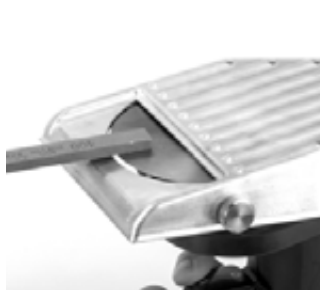
Das Schneidmesser von oben abschleifen.
