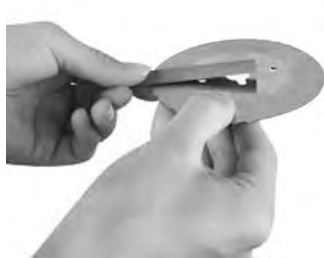
Сгладьте нижнюю часть лезвия спереди.
