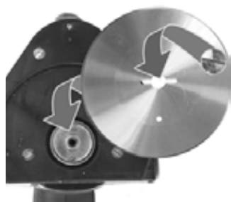
Τοποθετήστε τον νέο κόφτη και βιδώστε τον δίσκο συγκράτησης με τη βίδα στερέωσης.
