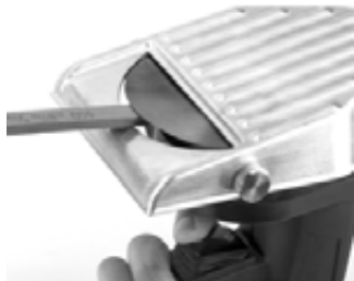
Затачивайте круглое, гладкое режущее лезвие в течение примерно 1-2 секунд под небольшим углом по отношению к горизонтальной плоскости.
