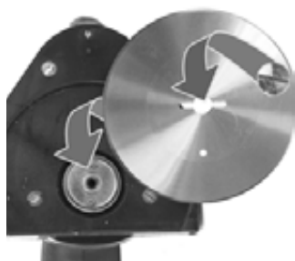
Założ nowe ostrze, przykręć tarczę przytrzymującą i śrubę mocującą.
