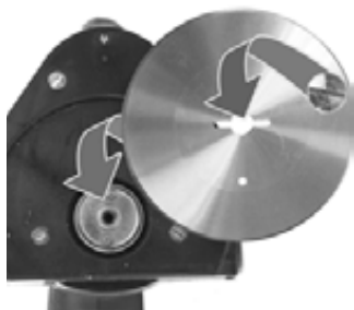
Вставьте новое лезвие, затяните фиксирующий диск и крепежный винт.
