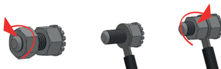
Rys. 3. Podłączenie urządzenia do instalacji wyrównującej potencjały elektryczne.
